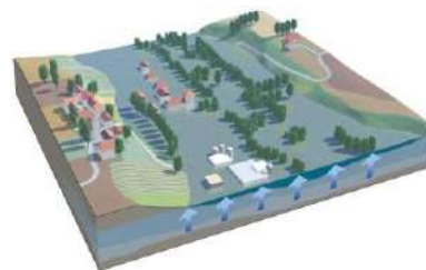
Inondation de nappe
